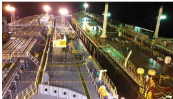
Proses swapping FSO Pertamina Abherka (kanan) dengan MT Galunggung (kiri) secara STS ( ship to ship ).
